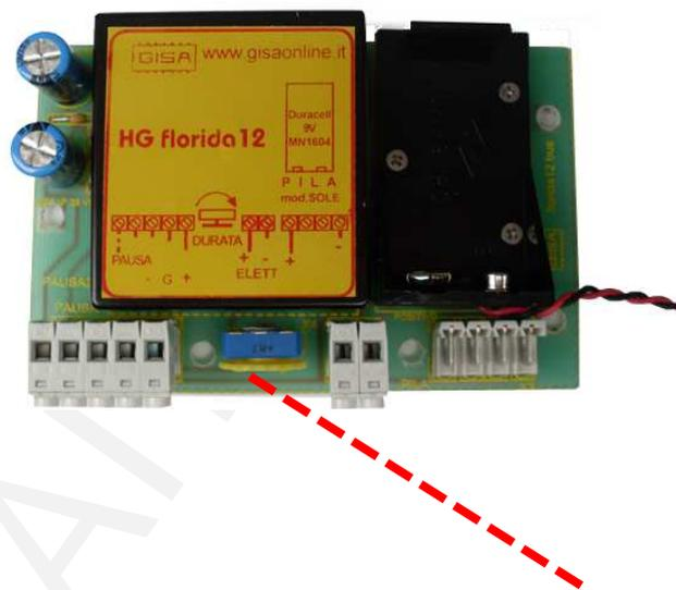
**OPERAZIONE B** - Ruotare rotellina del *trimmer* almeno 20 (venti) volte in senso orario e in senso antiorario fino ai fine corsa.
