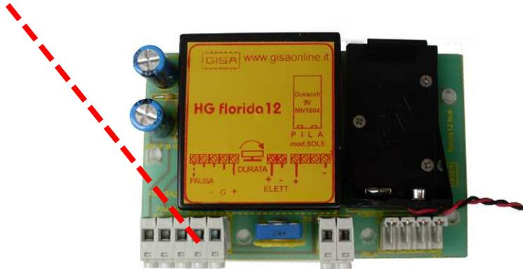
**OPERAZIONE D** - Estrarre e reinserire il morsetto della elettrovalvola almeno 5 volte.
